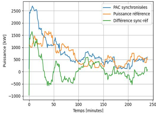
Synchronisation virtuelle de 30 PAC, le 17 mars 2020 à 10h, courbes de puissance agrégée de toutes les PAC, de puissance de chauffage de référence et de différence entre la puissance synchronisée et la puissance de chauffage de référence. La courbe de chauffage de référence correspond à la courbe de charge normale des 30 PAC lorsqu'aucune synchronisation n'est effectuée et sert de comparaison pour comprendre l'effet de la synchronisation.
