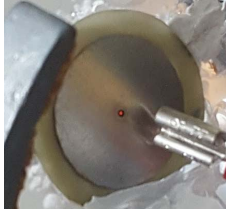
Figure 35 : Test de génération de plasma dans un PCB bouché
