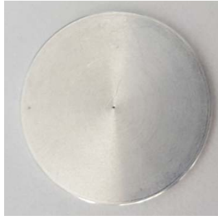
Figure 8 : Electrode avec un trou de 0.2mm de diamètre en aluminium
