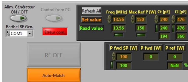
Figure 24 : Page Labview pour le contrôle l'alimentation MHz
