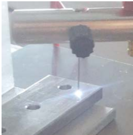
Figure 2 : Plasma entre une pointe et une plaque
