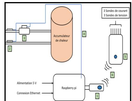
Schéma fonctionnel du système d'acquisition de données utilisé.
